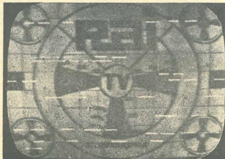
Fig. 22 - Interferenza causata da segnali radio a frequenze medie.
